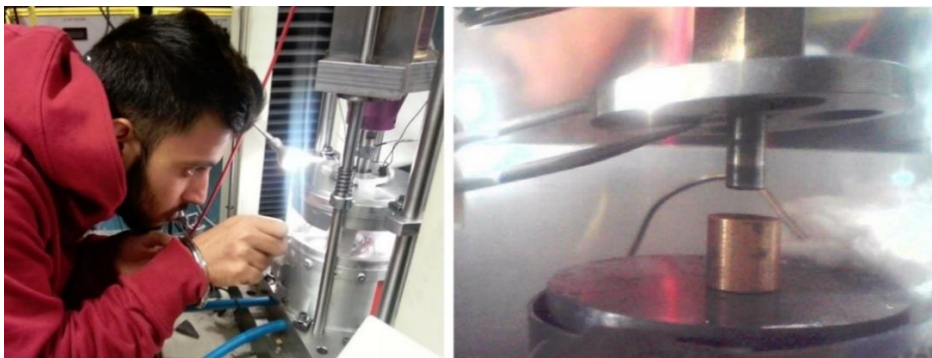
Rys. 2. Realizacja procesu ultradźwiękowego mikrospęczania w LMP
